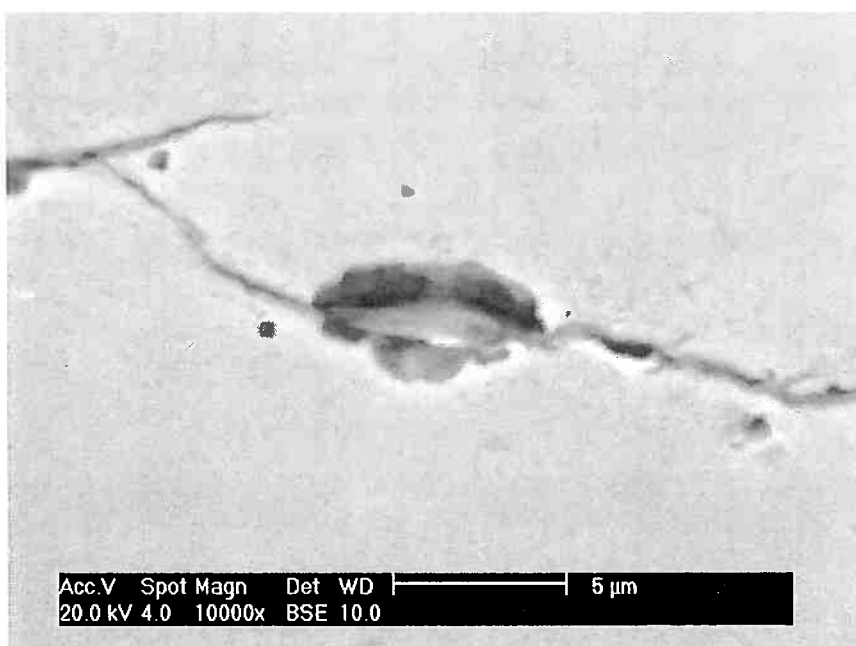
Figura 50: Possível inclusão no caminho da trinca. Aumento 10.000X
