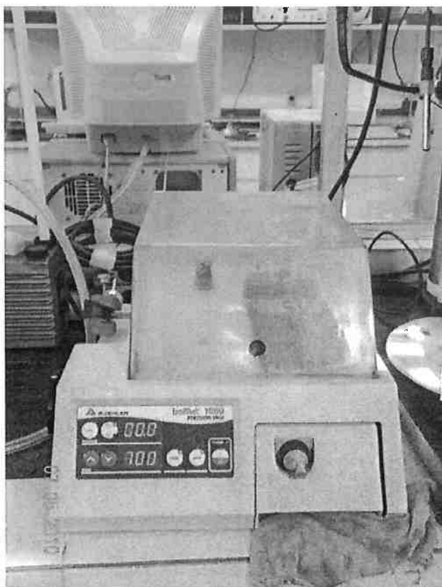
Figura 18: Equipamento utilizado para cortar os corpos-de-prova sem danificar ou ocultar possíveis trincas. (PMT/USP)
