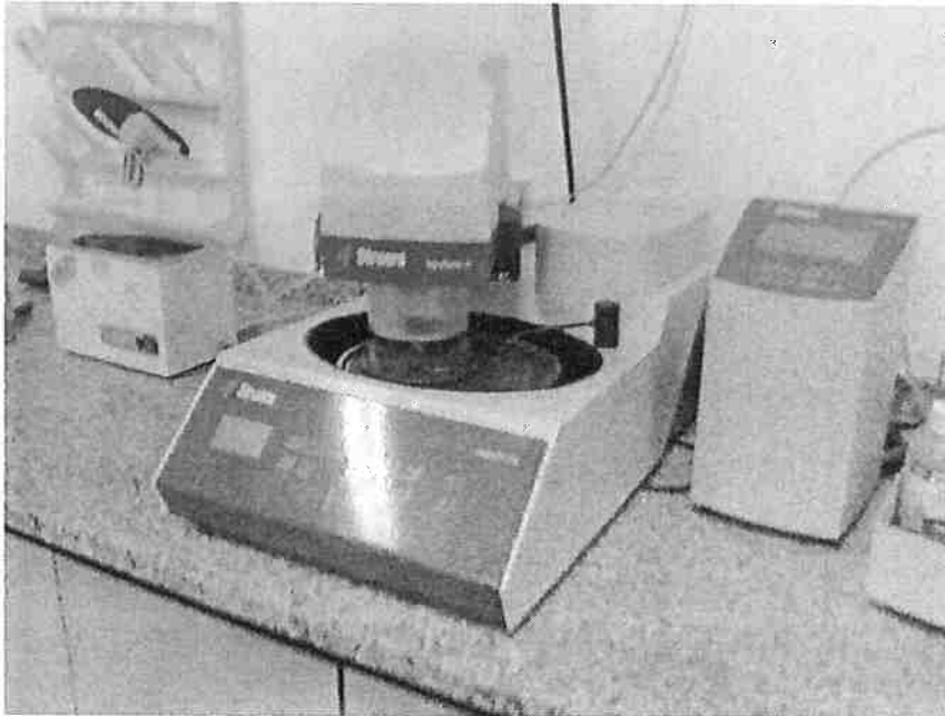
Figura 11: Equipamento rotativo utilizado para lixamento e polimento (LFS/USP).
