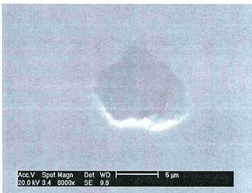
Figura 31: Observação de inclusão arredondada. Aumento 8.000X
