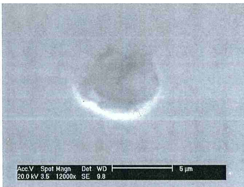
Figura 33: Observação de inclusão arredondada. Aumento 12.000X
